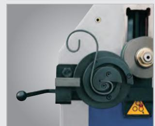
③ Dispositif à réaliser les volutes et spirales (en option)
