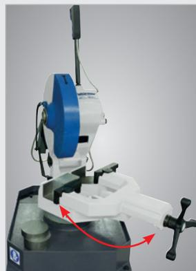
• Etau à serrage rapide avec une rotation de  $\pm 45^\circ$
