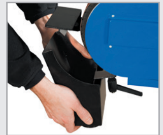
• Boîte à copeaux, facilement amovible (Fig. : MBSM 150-200-2)
