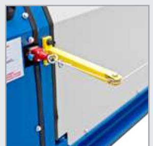
· Palier hydraulique repliable pour faciliter l'enlèvement des pièces finies
