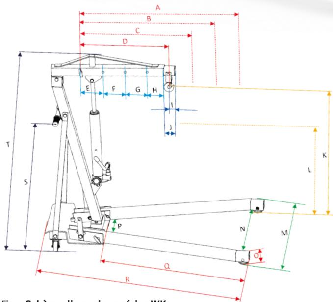
Fig. : Schéma dimensions séries WK
