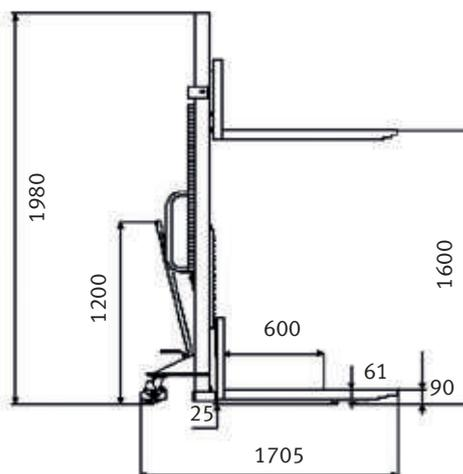
Fig.: schéma GHHW 1000
