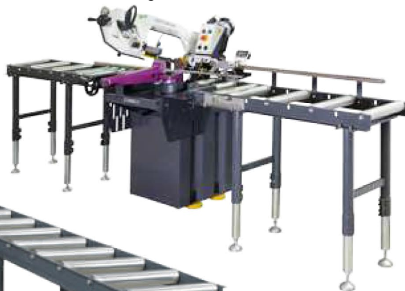
Fig.: S 275N avec MSR 1, MSR 4, LMS-1M, LMS-2M et afficheur digital DRO 1
